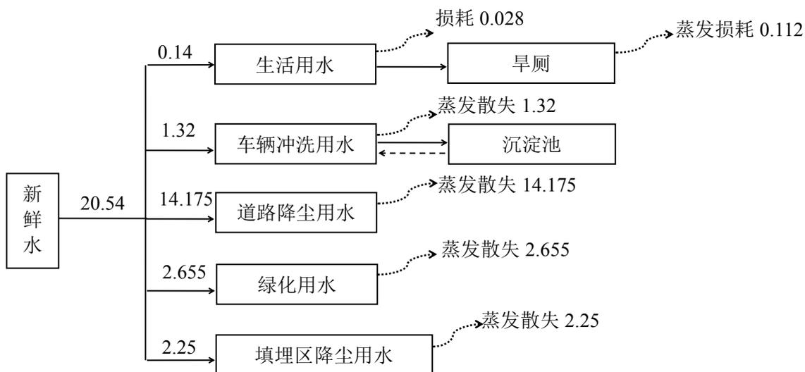
图 2-1 本项目水平衡图 (单位:  $\text{m}^3/\text{d}$ )
