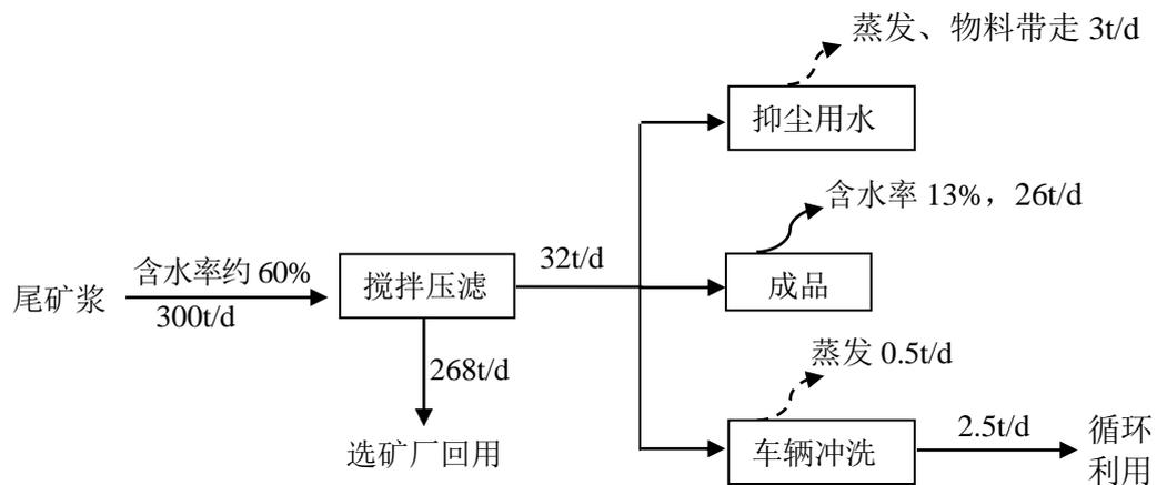
图 2.1 项目工程水平衡图
