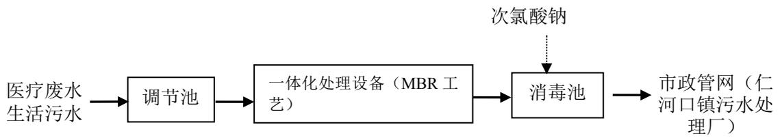
图 4-1 项目废水处理工艺流程图
