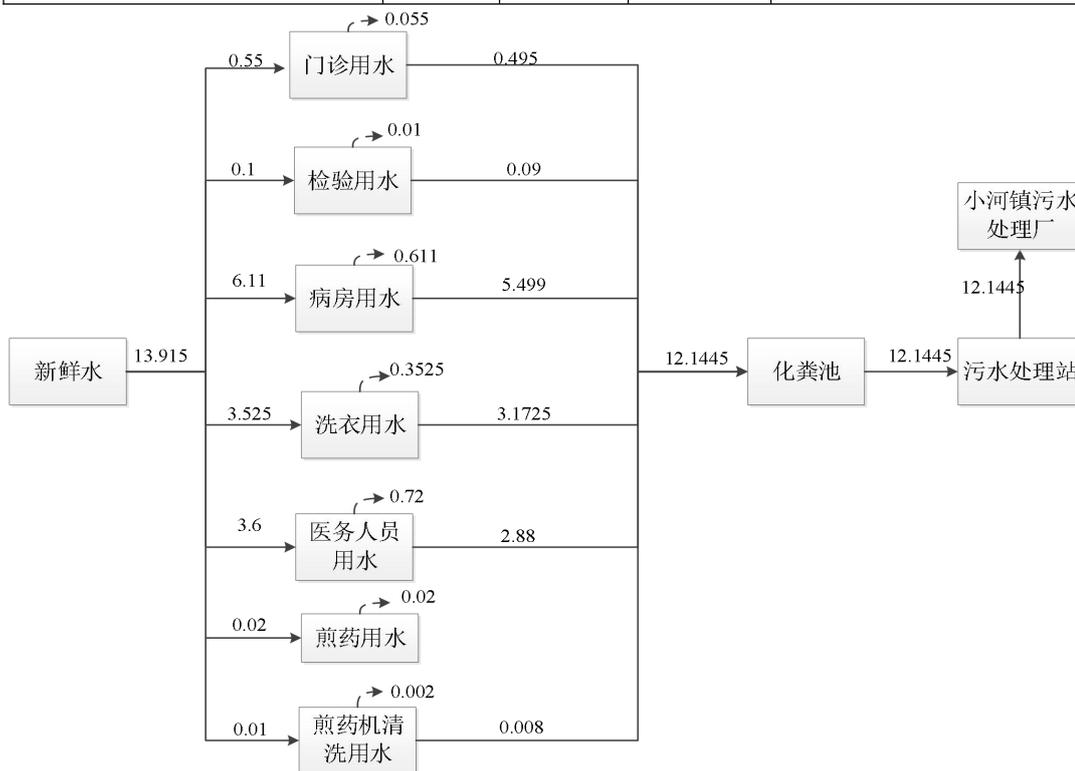
图 2-1 水平衡图 (m³/d)
