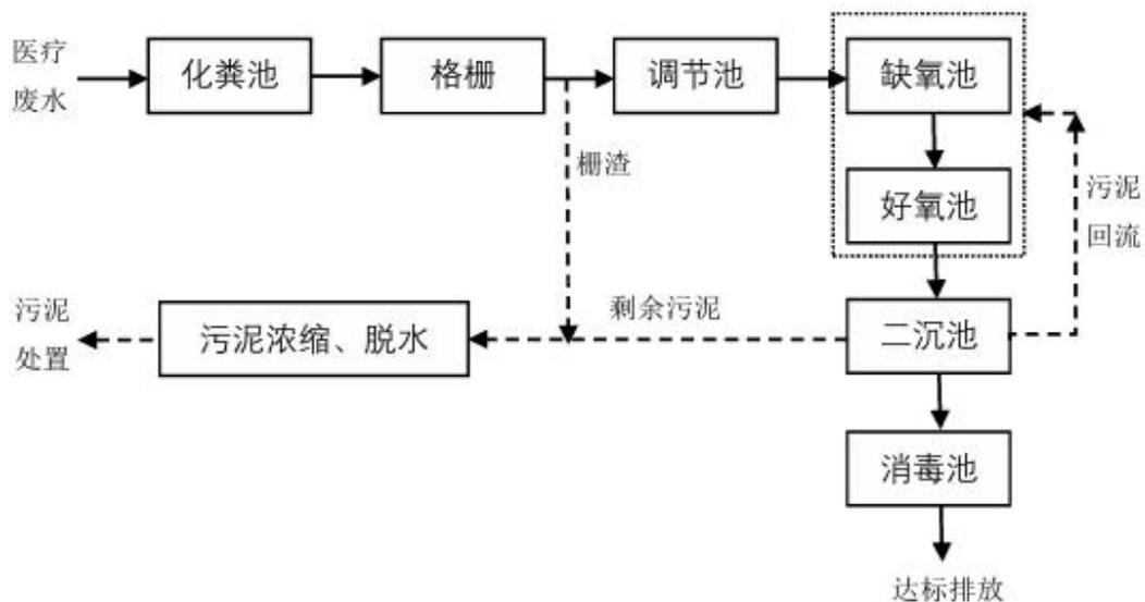
图 4-1 本项目废水处理工艺流程图
