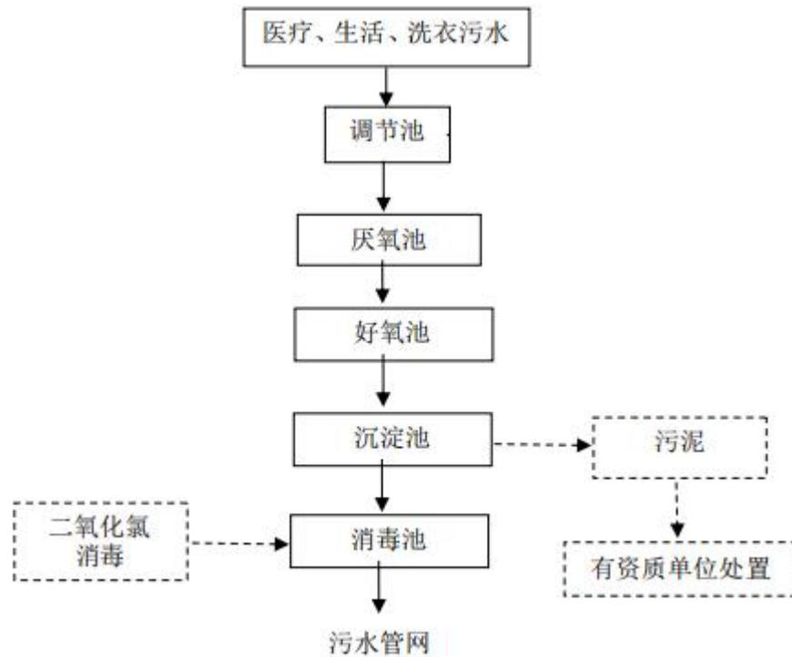
图 4-1 本项目污废水处理工艺流程图
