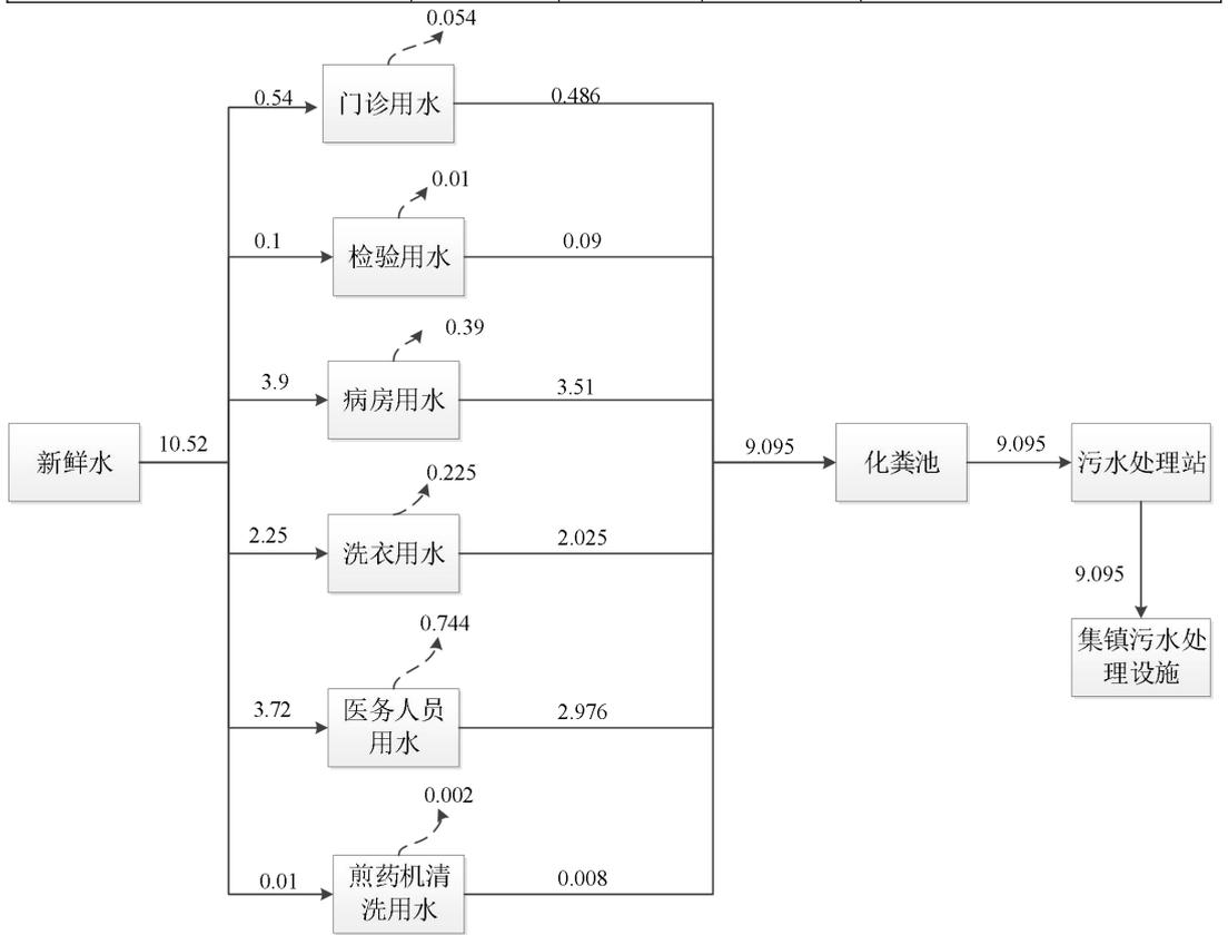
图 2-1 水平衡图 (m<sup>3</sup>/d)
